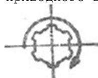
б) ходовая зависимость вперёд, включение 1-4 передачи, направление вращения приводного вала (вид на вал).
